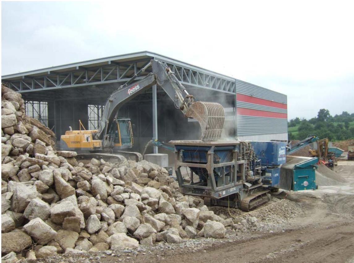
Der Aufbereitung dient eine kettenmobile Prallmühle mit einem nachgeschalteten Doppeldeckersieb. Auf dem Bild unten ist der Austrag aus der Prallmühle bzw. der Eintrag in die Siebanlage zu sehen. Am Austrag ist ein Bandmagnet zu erkennen, der Eisenmetalle (bspw. aus der Bewehrung) entnimmt. Bei der Siebanlage ist die erste Siebstufe zu erkennen, über die das Überkorn abgetrennt wird.
