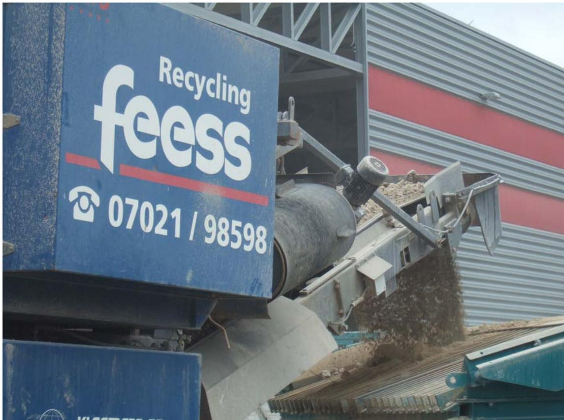
Danach wird der Materialstrom dem eigentlichen Doppeldeckersieb zugeführt, wobei auch hier noch eine weitere Metallabscheidung erfolgt. Mit dem Sieb erfolgt eine Auftrennung in die Materialströme mit den Korngrößen (16/x mm; 30%), (2/16 mm; 45%) und (0/2 mm; 25%). Die Zielkorngröße für die Herstellung des Betonzuschlags stellt die Fraktion (2/16 mm) dar.
