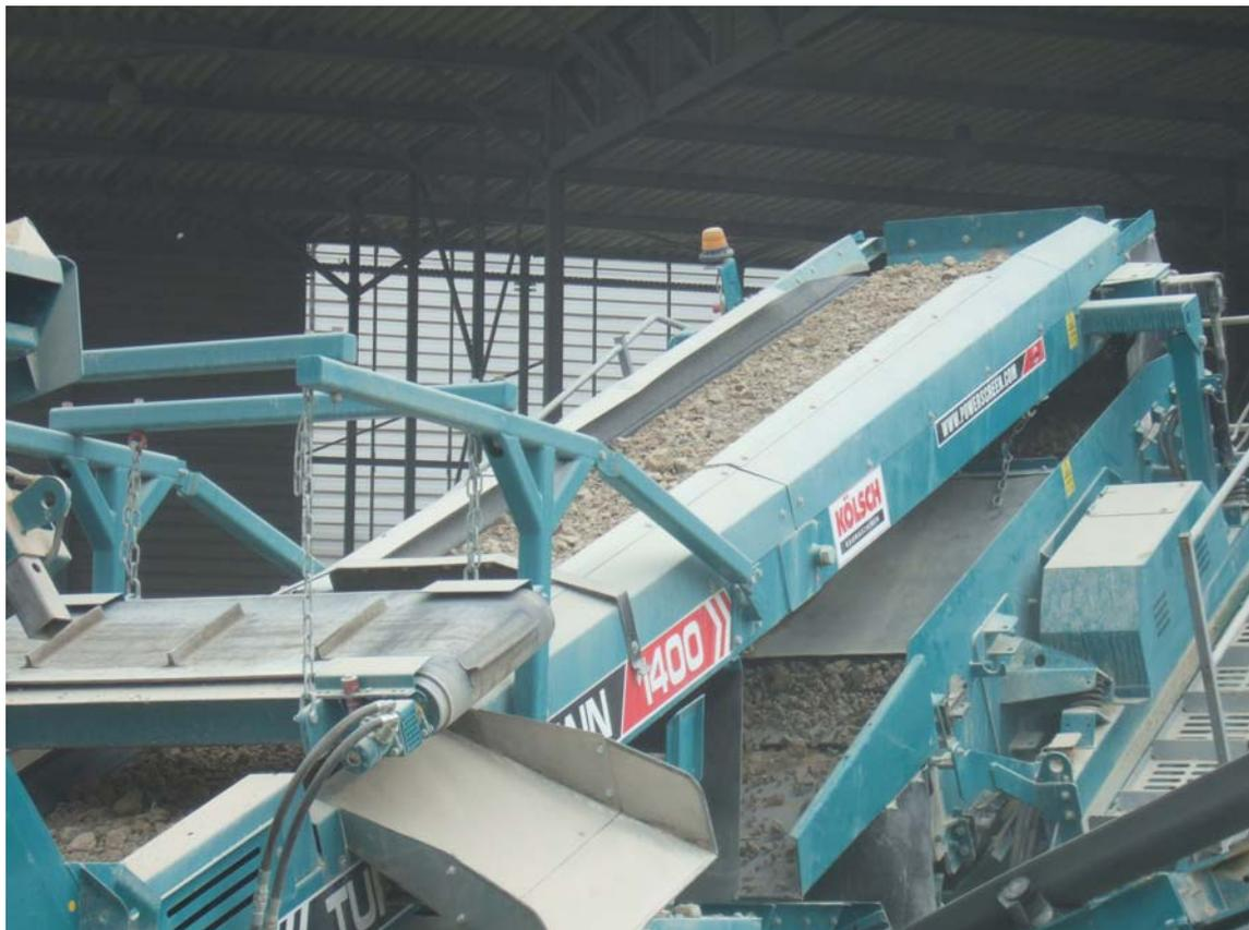
Auf diese Weise entstehen mit dem Brechsand und der RC-Gesteinskörnung zwei Produktmassenströme. In dem Sand dürfte ein hoher Anteil an Zementstein enthalten sein, der beim Brechvorgang vom Altbeton abgeschlagen wurde.
