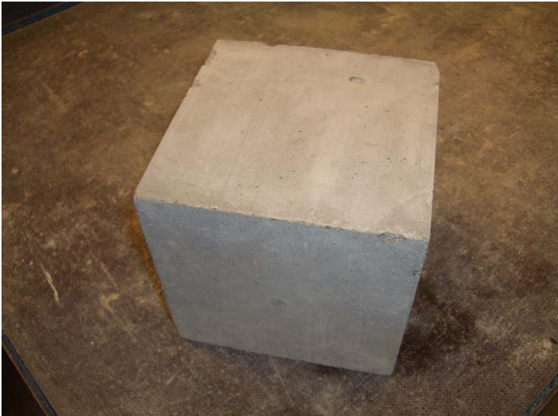
Werden Rezepturen erstmals hergestellt, müssen sie einer umfangreichen Erstprüfung unterzogen werden. Dies war auch im Falle der genannten Rezepturen unter Verwendung von RC-Gesteinskörnung notwendig. Die Prüfung erfolgte über das Krieger Beton-Technologiezentrum in Remseck-Neckarrens.
