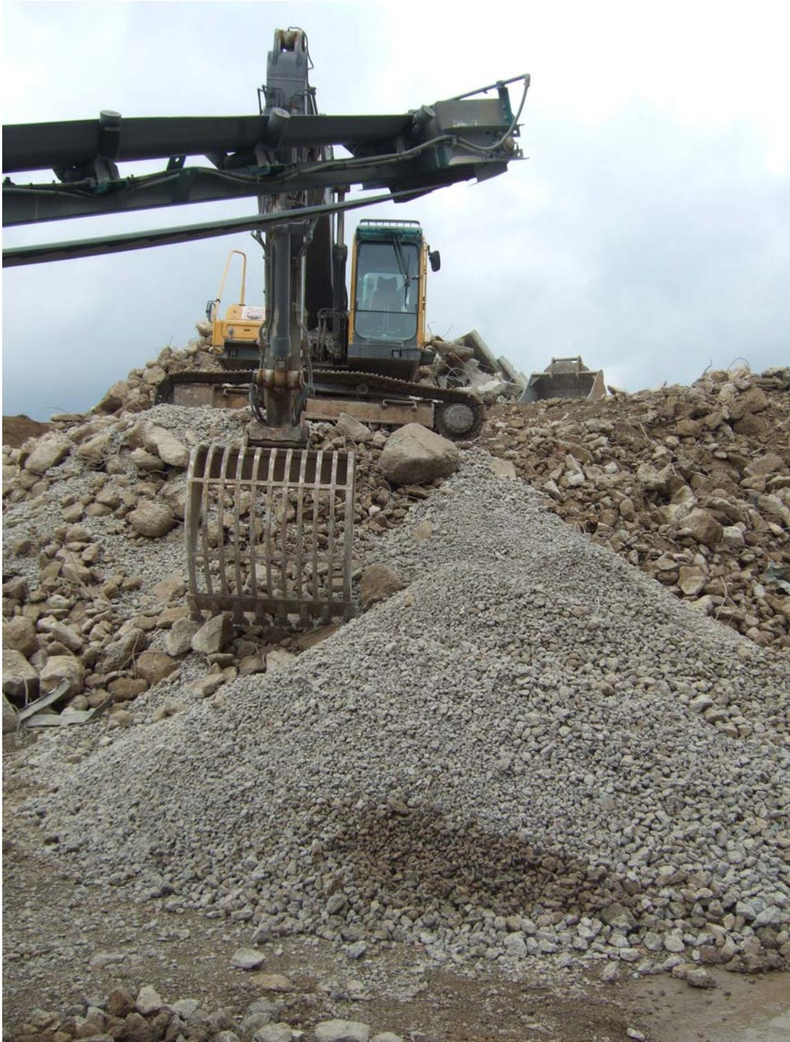
Die Fraktion in der Korngröße (16/x mm) wird deshalb erneut der Prallmühle zugeführt. Dieser Materialstrom durchläuft den oben bereits geschilderten Aufbereitungsprozess zum zweiten Mal. Aus diesem zweiten Aufbereitungsprozess entstehen Korngrößen, die zu 60% der Zielgröße entsprechen. Jeweils 20% fallen als Sand (0/2 mm) oder als
